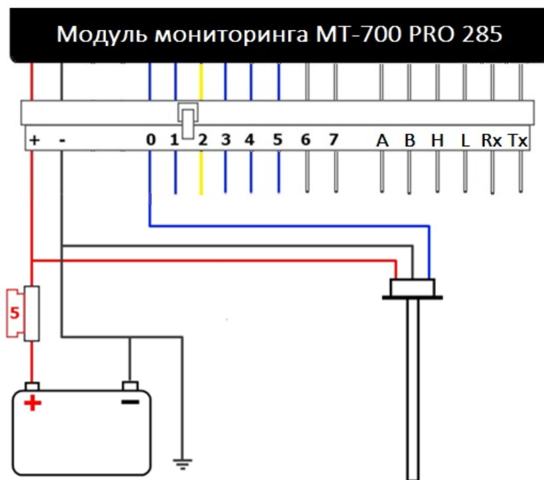
Рисунок 2 – Схема аналогового датчика уровня топлива к МТ-700 Pro 285
